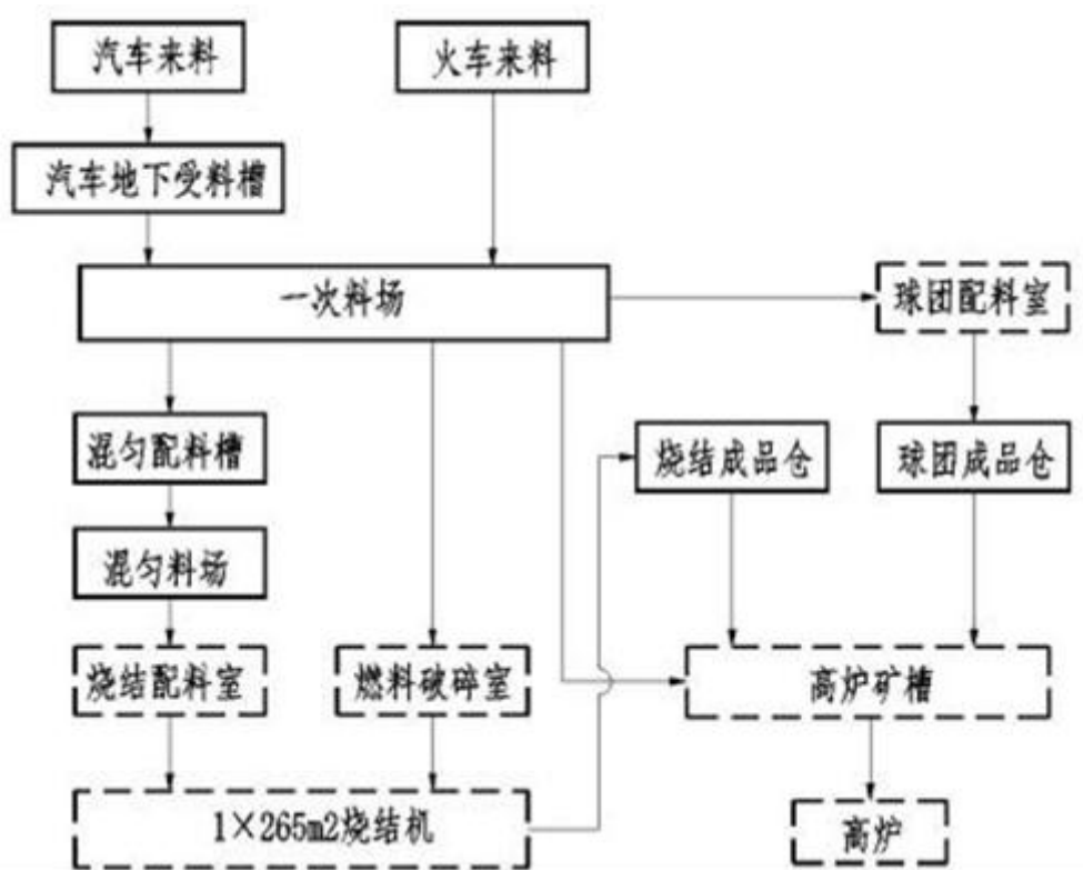
图 5.2-1 原料场工艺流程图
