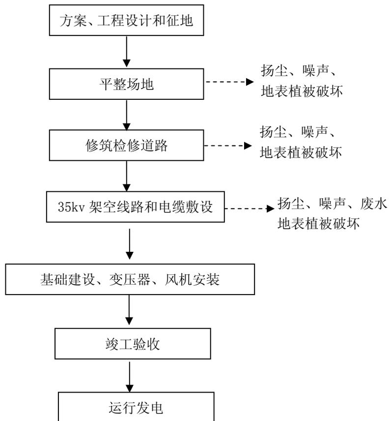
图 5 本项目施工期流程及产污环节图
