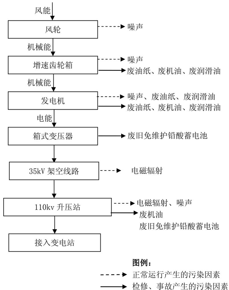
图 6 本项目营运期工艺流程及产污环节图
