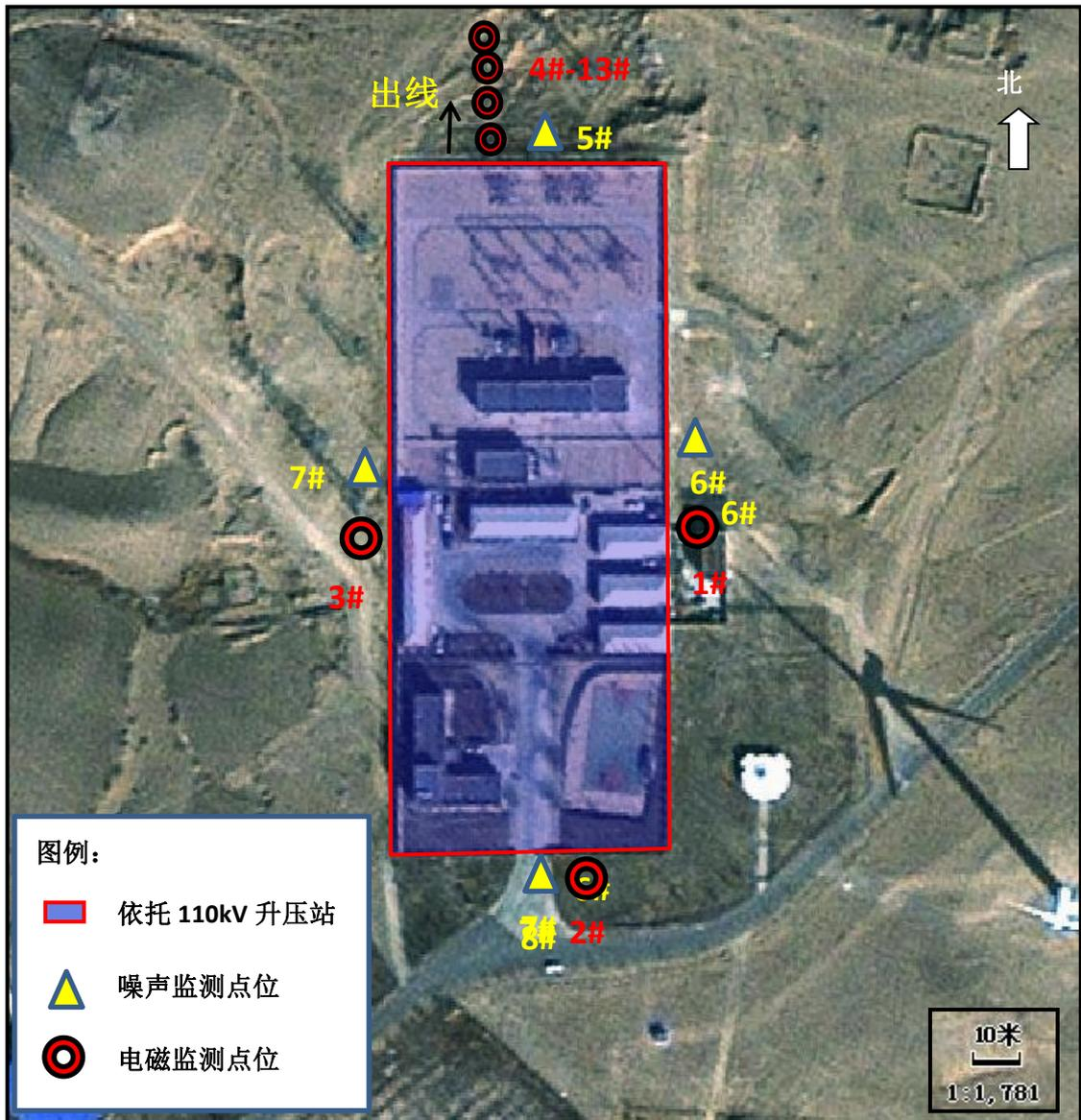
图 13 本项目依托 110kV 升压站监测点位示意图
