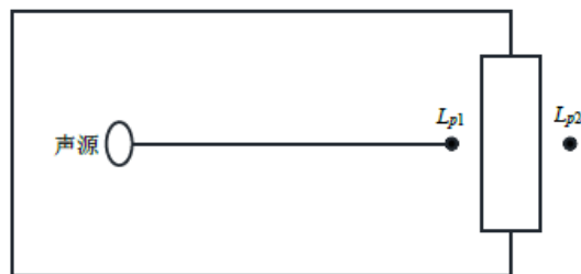
图 6.5-1 室内声源等效为室外声源图例
