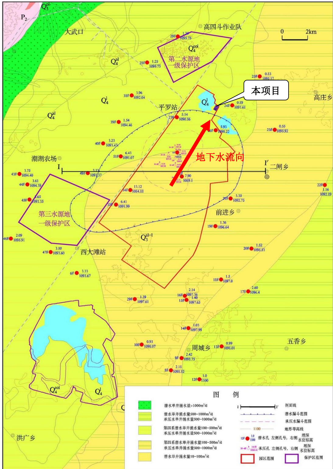
图 5.2-1 本项目与石嘴山第二水源地位置关系及区域水文地质图
