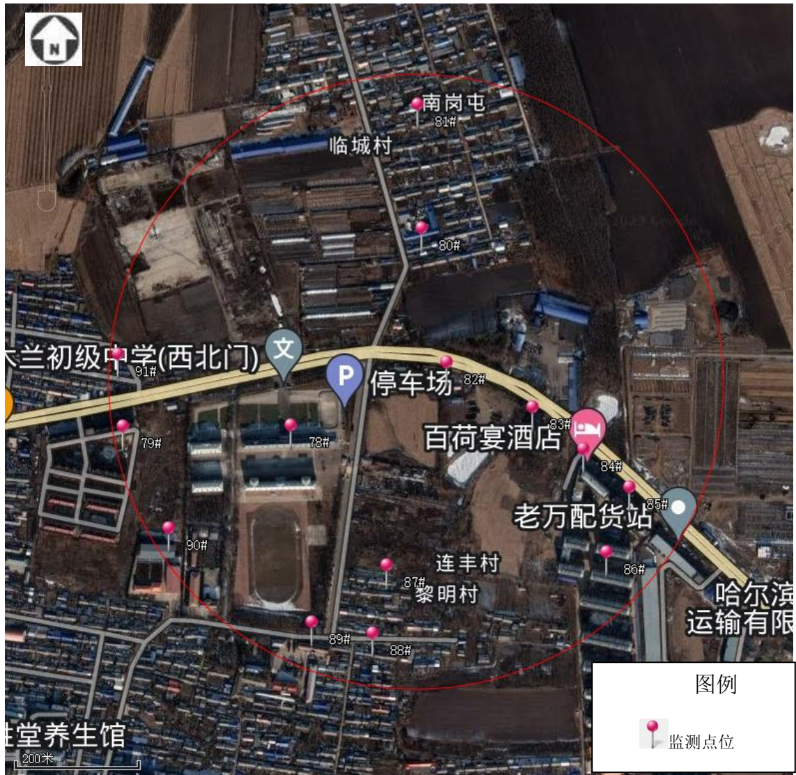
专题图 8 主要电磁辐射环境敏感目标处电场强度、磁场强度监测点位图
