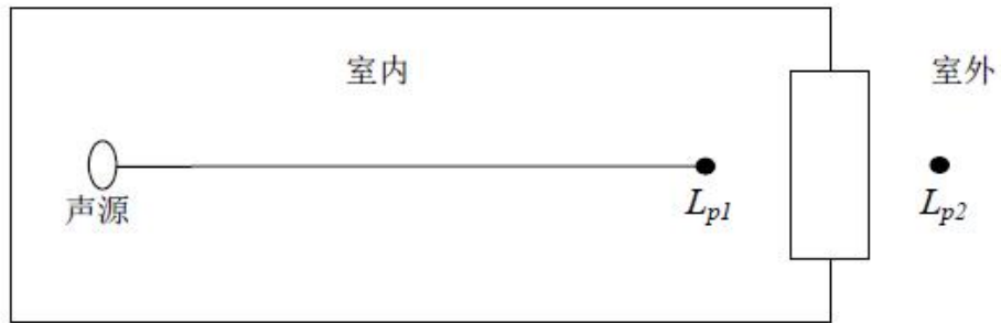
图 4-1 室内声源等效室外声源图例
