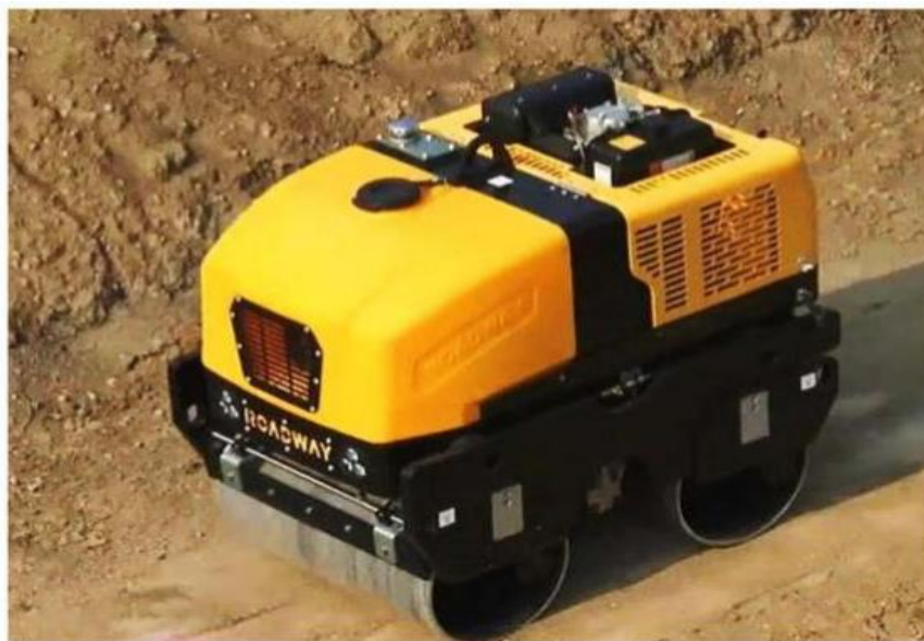
图 4.8-3 无人压实机作业情况示意图
