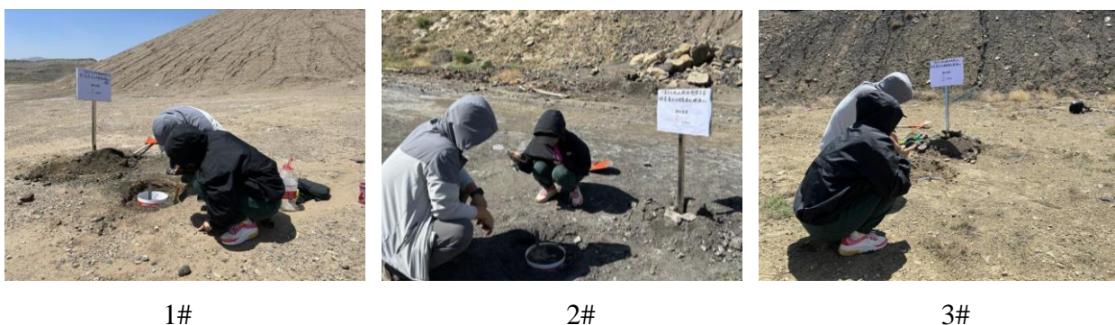
图 7.3-4 渗水试验现场照片
