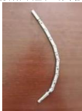
图 9-5 ^{60}\text{Co} 源带钨合金源辫
