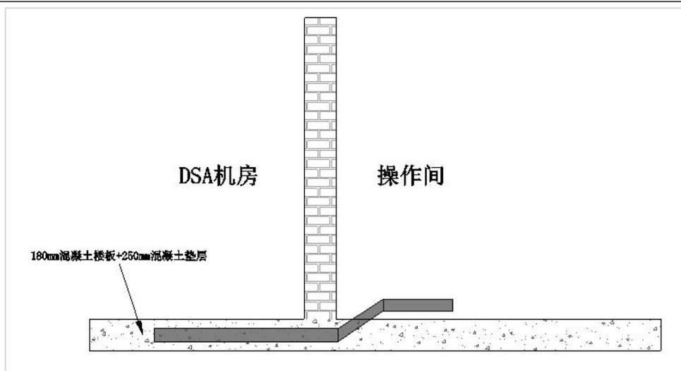
图 10-6 电缆穿墙示意图
