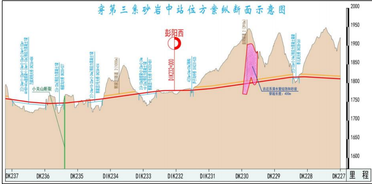
图4.6-3 越岭段推荐彭阳西中站位方案纵断面示意图
