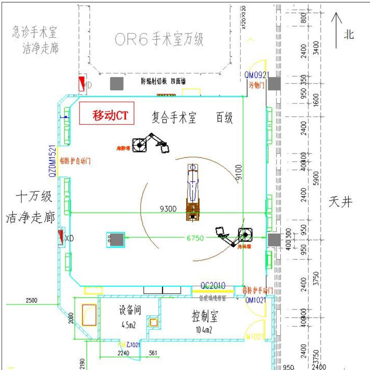
图 1-7 本项目急诊楼四楼西侧复合手术室平面设计图
