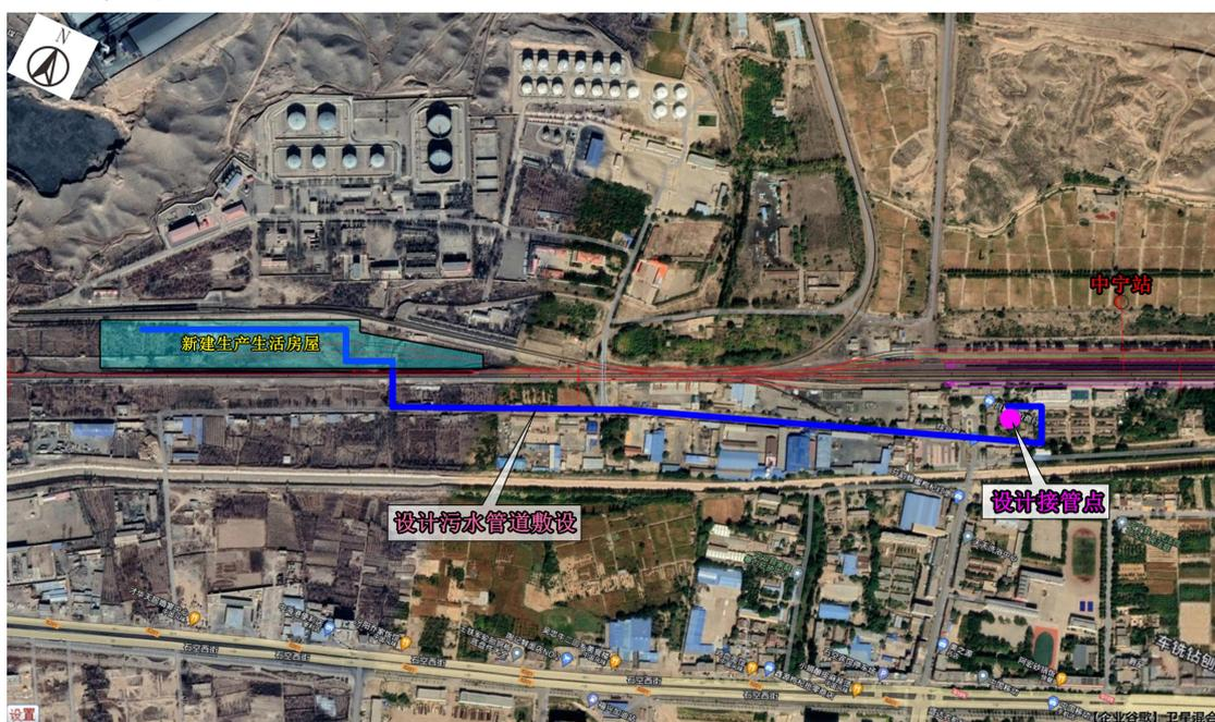
图 9.3-6 中宁站设计污水接管示意图
