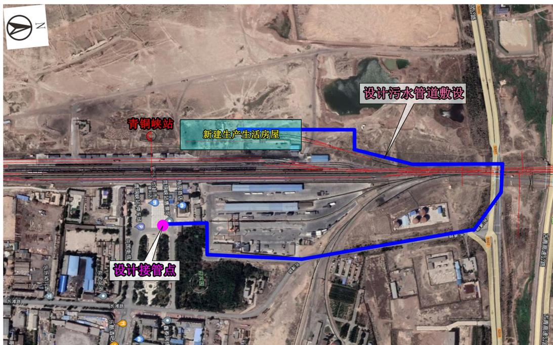
图 9.3-4 青铜峡站设计污水接管示意图
