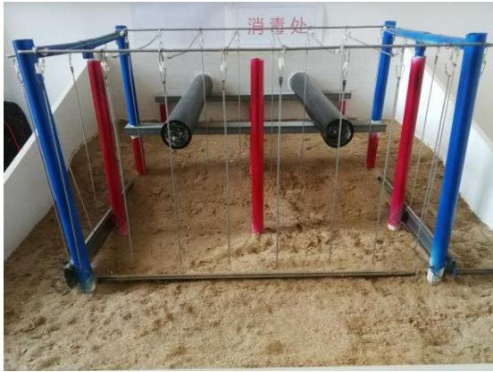
图 7.5.3-1 取水管道口电子脉冲拦鱼器示意图
