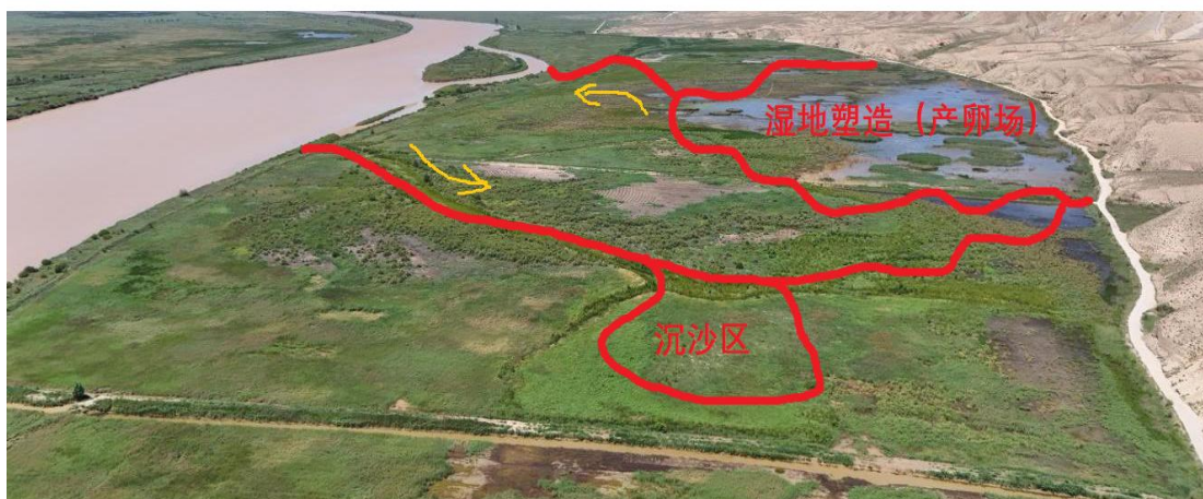
图 7.5.4-3 牛轭弯河曲结构改造功能区
