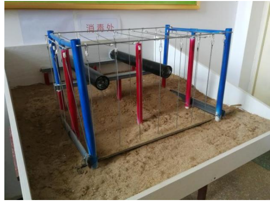
图 7.5.3-1 取水管道口电子脉冲拦鱼器示意图
