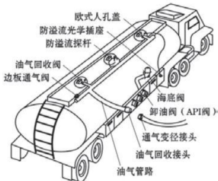
图 2.2-6 油罐车油气回收装置示意图
