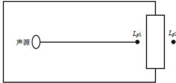
图 6.5-1 室内声源等效为室外声源图例
