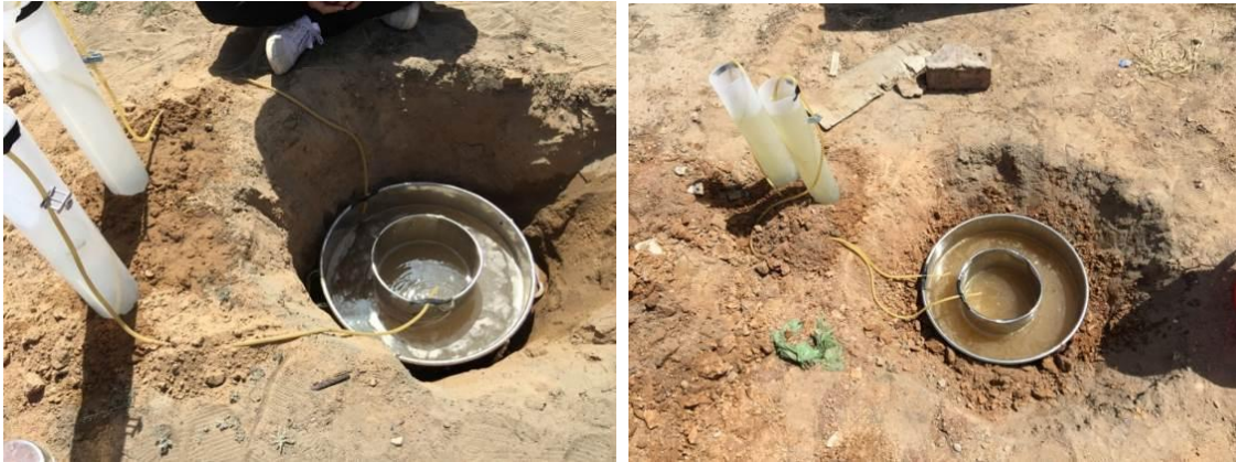
图 6.4-8 包气带渗水试验现场(左: S1#、右: S2#)
