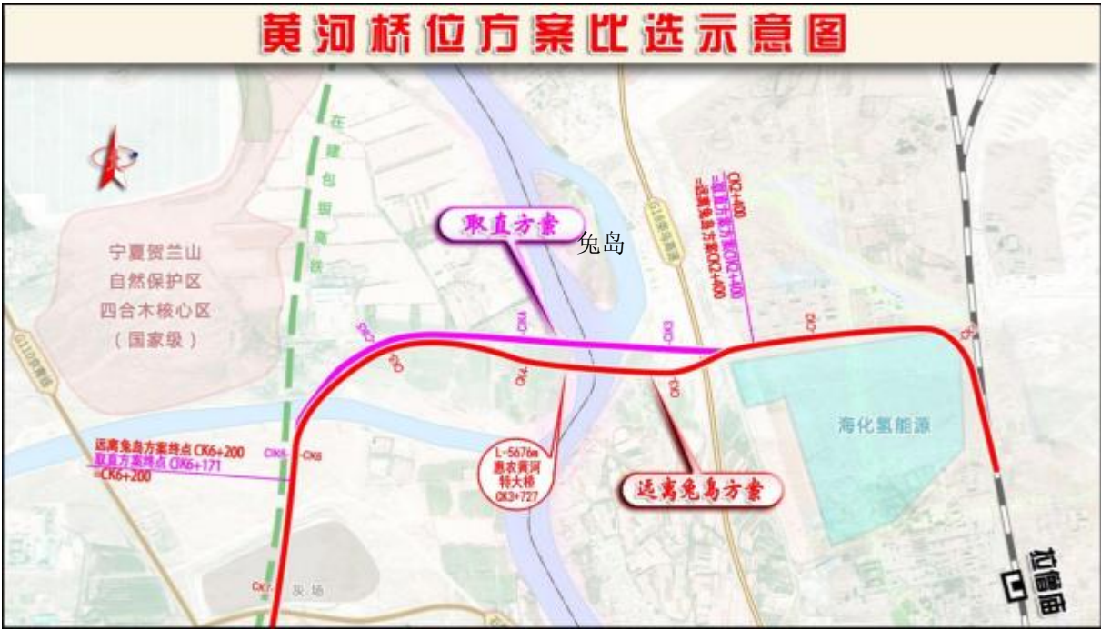
图 2.7-4 黄河桥位比选方案示意图
