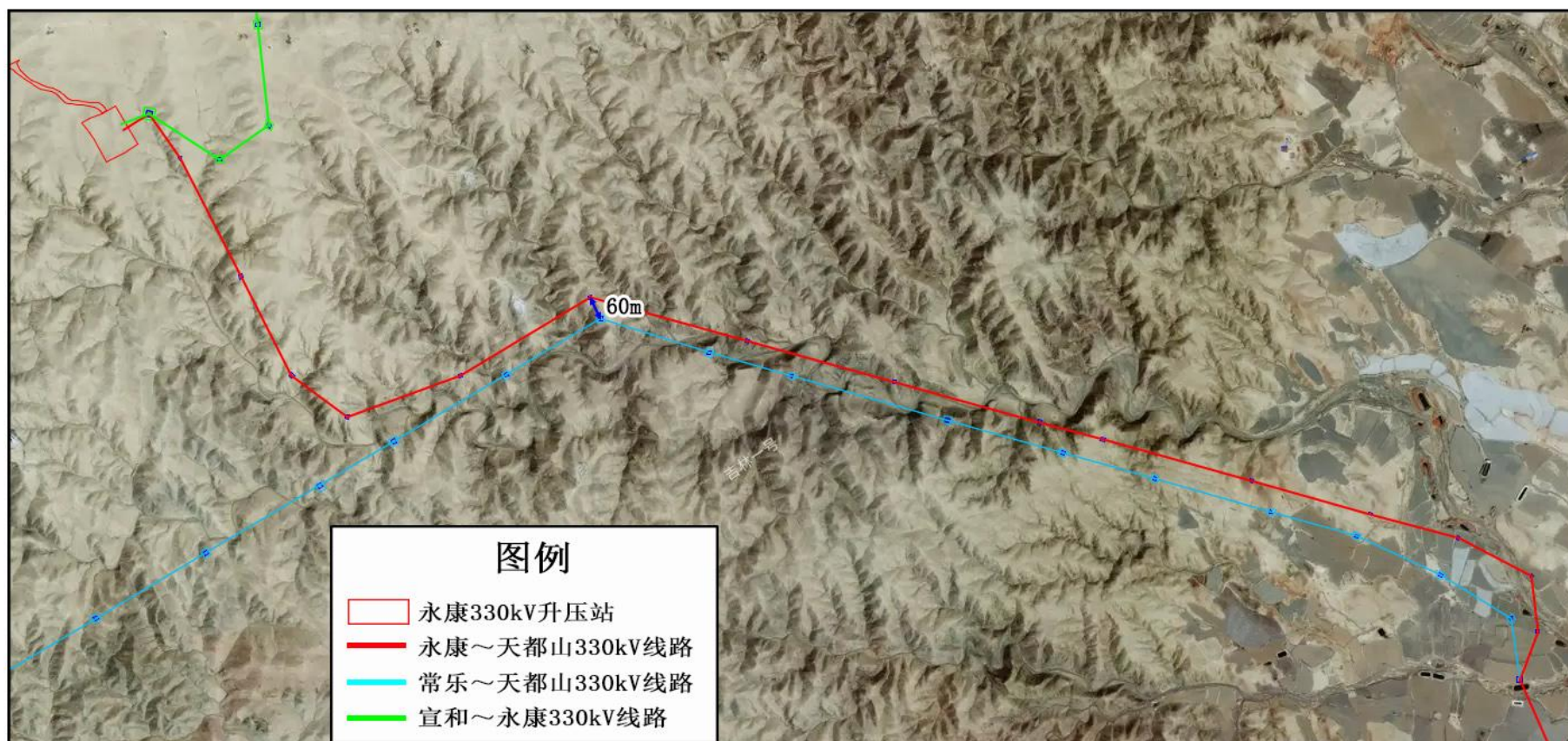
图 6.1-16 本项目 330kV 线路并行情况示意图
